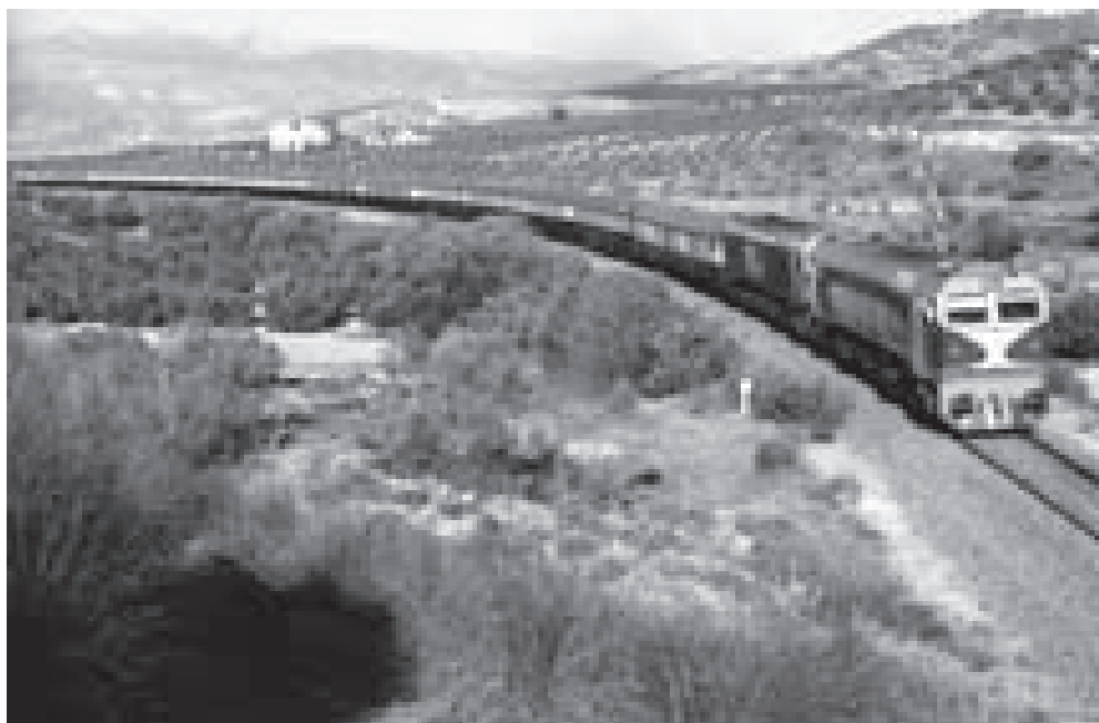
Foto 2.- La denominada "Herradura de Larva" es un lugar de culto para todo aficionado que desee presenciar las locomotoras emplearse a su máxima potencia al negociar las fuertes pendientes de las proximidades de las estación de esa localidad. La imagen recoge el momento en que el Al-Andalus, hoy tristemente fuera de servicio, asciende penosamente a poca velocidad traccionado por dos 319-3 en mando múltiple con sus reguladores a fondo. ¡Todo un espectáculo para ver y oír! Servicio Linares-Granada. Mayo de 2003. Foto Mario Fontán Antúnez.
