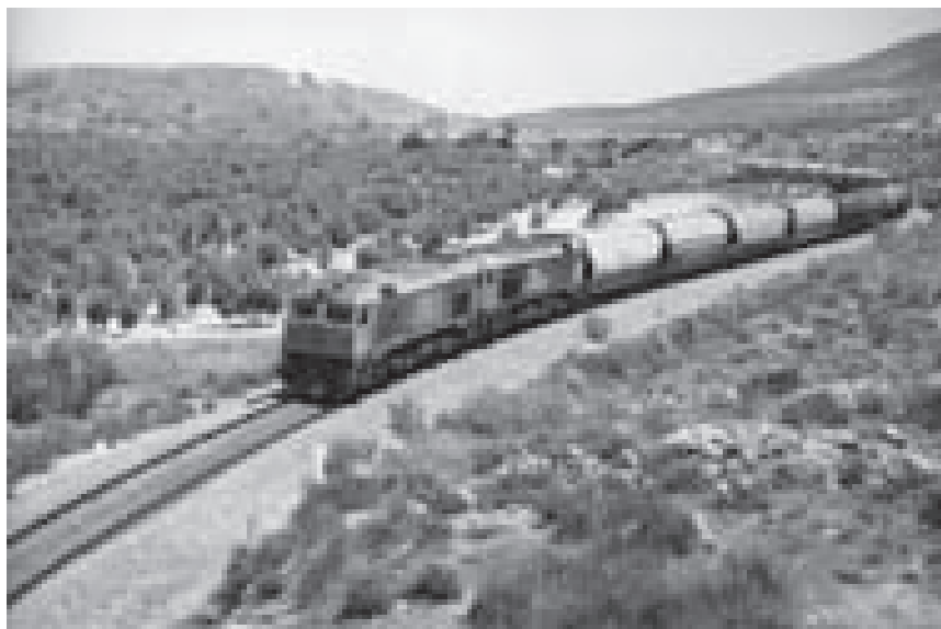
Foto 4.- La dureza del trazado entre Larva, Huesa y Cabra del Santo Cristo se hace patente en esta imagen: doble tracción de las 319-313 y 319-310 asegurando al cargas nº 93335 que se contonea en curva y contra-curva, a la vez que desciende con sus frenos dinámicos activados al máximo para retener la composición. Obsérvese que la locomotora de cabeza luce una no muy vistosa decoración de lo que hoy se da en llamar “arte del graffiti” que por esa época empezaba a imponerse –nunca mejor dicho- en el material ferroviario. No tengo nada en contra de este denominado arte, pero jamás admitiré su imposición en lo público o privado, en un mal uso de las libertades. Mayo de 2003. Foto Mario Fontán Antúnez.
